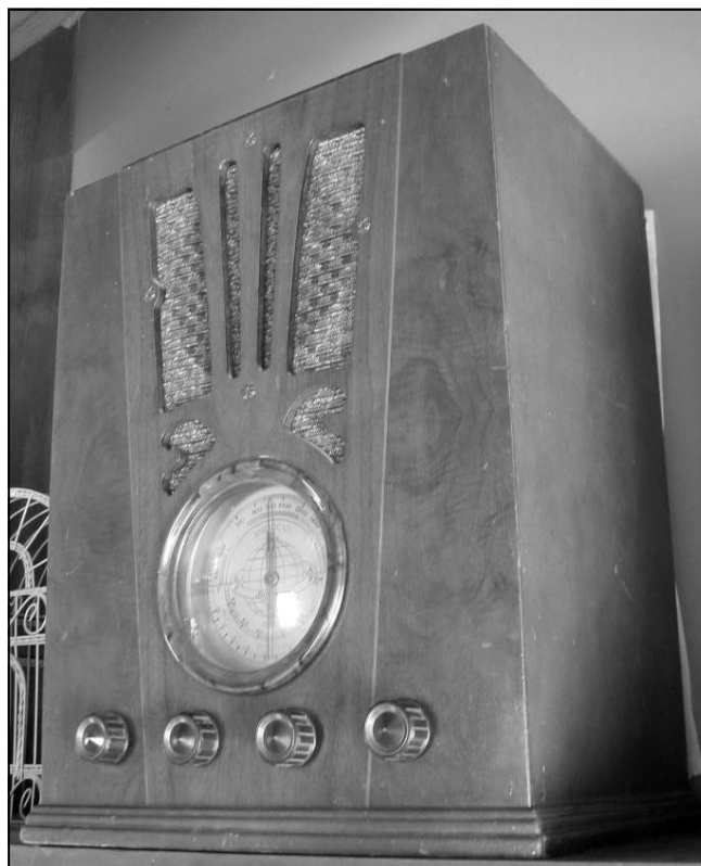
Appareil radio modèle de table Silvertone 1936 de Sears Roebuck , bande AM plus deux bandes d'ondes courtes, dans son état actuel. Il fonctionne encore très bien. Le cadran doré est éclairé. Les quatre boutons qu'on voit ici ne sont pas d'origine. (Photo Valérie Caron, mars 2011).
